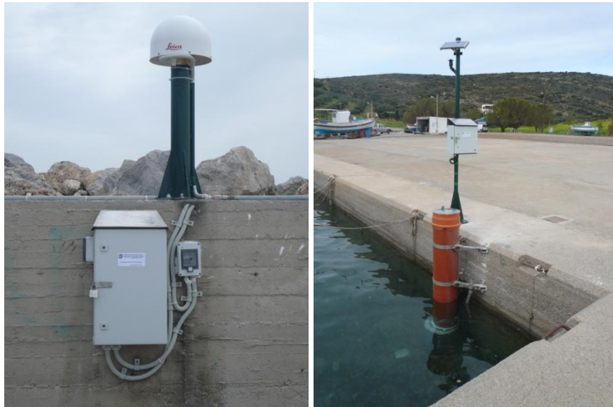
Μόνιμος ψηφιακός παλιρροιογράφος και δορυφορικός σταθμός στο Παλαίκαστρο Κρήτης.
