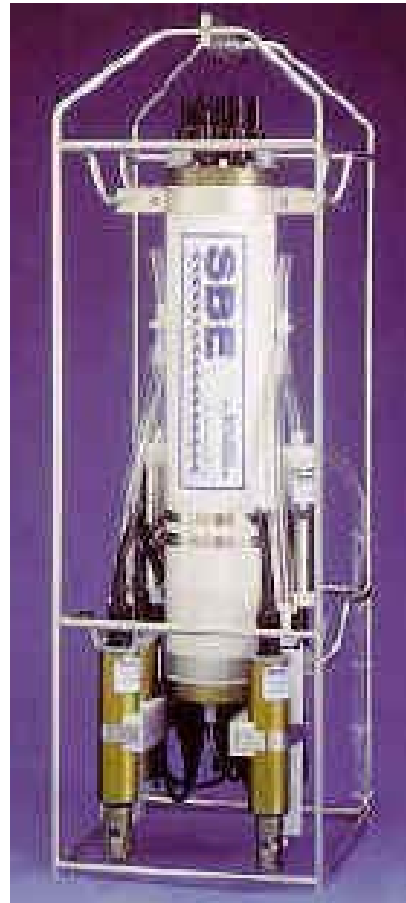
Σχήμα 1.4 Τυπικό CTD της δεκαετίας του 1990, εξοπλισμένο με αντλίες κυκλοφορίας του νερού στους αισθητήρες.
