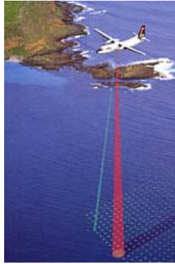
Εικόνα 4. Βυθοσκόπηση παράκτιων περιοχών με χρήση Αερομεταφερόμενο Βυθόμετρο Laser
