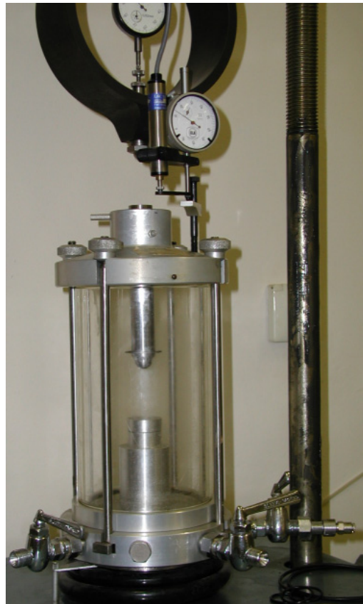
Σχήμα 8.4: Διάταξη τριαξονικής δοκιμής – κυψέλη, σχεδιάγραμμα (α) (Craig, Soil Mechanics), φωτογραφία (β) (φωτ. Εργαστήριο Δομικής Μηχανικής).
