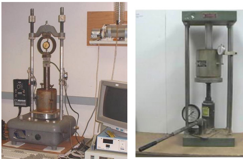
Σχήμα 7.1: Εργαστηριακή διάταξη για την δοκιμή CBR (α), συσκευή πεδίου (β) για χρήση σε εργοτάξιο.
