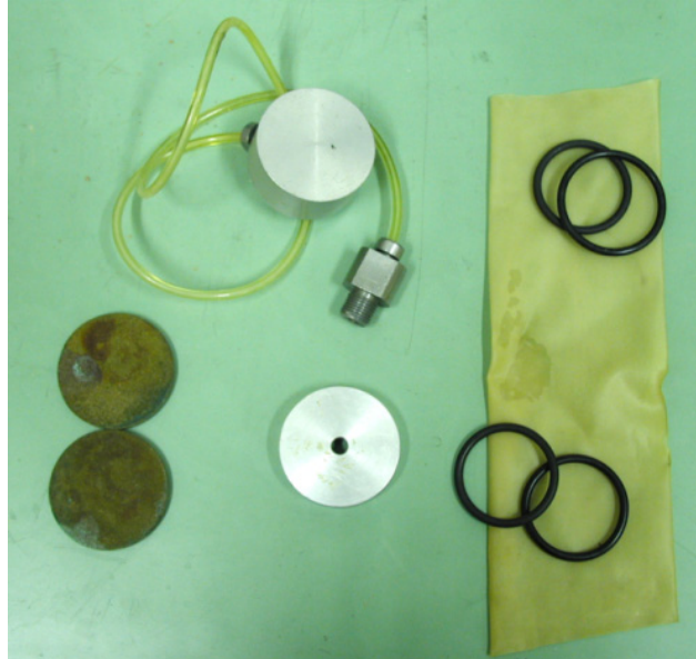
Σχήμα 8.6: Εξοπλισμός για την τριαξονική δοκιμή: Πωρόλιθοι, διάτρητες πλάκες φόρτισης, υδατοστεγής μεμβράνη, λαστιχάκια στεγανοποίησης. (φωτ.: Εργαστήριο Δομικής Μηχανικής)
