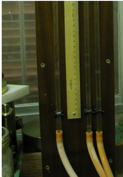
Σχήμα 6.2: Σωλήνες μανόμετρων (φωτ. Εργαστήριο Δομικής Μηχανικής)
