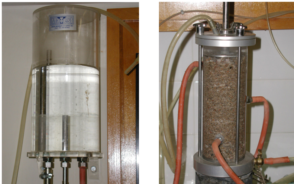
Σχήμα 6.1: Σύστημα παροχής νερού (α), Κυψέλη με εδαφικό δείγμα (β) (φωτ. Εργαστήριο Δομικής Μηχανικής)
