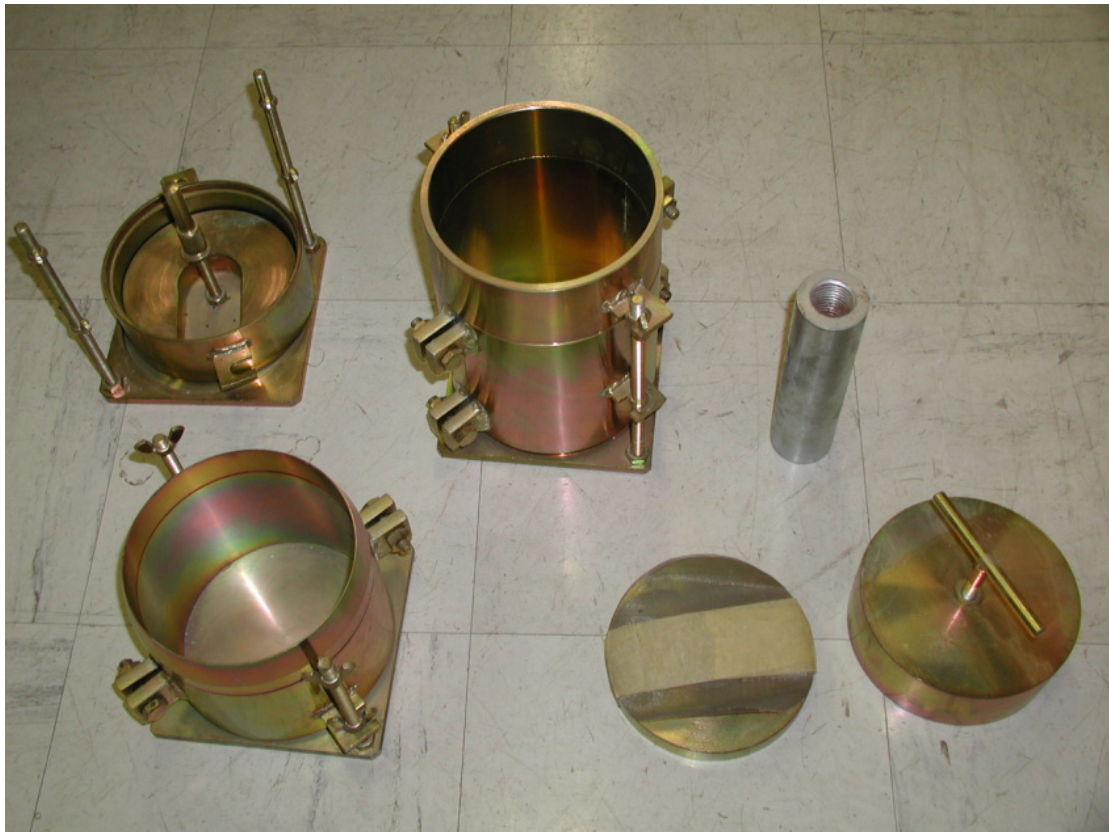
Σχήμα 7.2: Εξοπλισμός για τις δοκιμές CBR. Κάτω αριστερά διακρίνεται η κυψέλη για την δοκιμή αντοχής CBR. (φωτ. Εργαστήριο Δομικής Μηχανικής)
